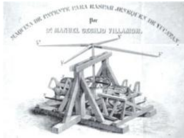
〈도 1〉 마누엘 세실리오 비야모르의 섬유 추출기 (출처: AGN, Patentes y Marcas, C. 41, Exp. 1657)
