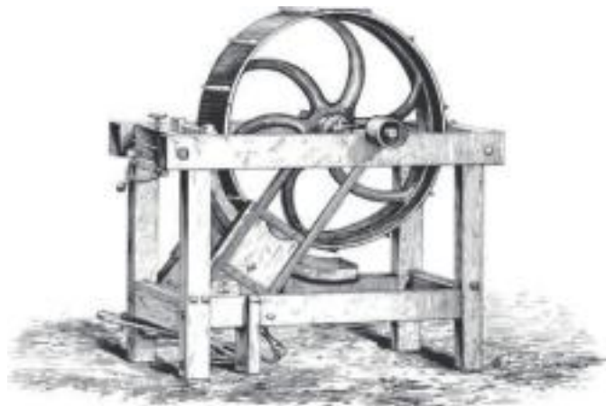
〈도 2〉 RUEDA RASPADORA DE SOLIS. 호세 에스테반 솔리스의 섬유 추출기 (출처: Segura, José C., El maguey, lám. 17)
