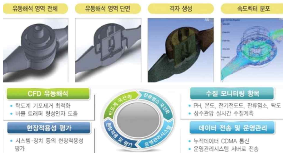
[그림 3.4] 스마트 미터 성능향상을 위한 CFD 유동해석 및 다항목 수질계측 시스템의 고도화 방안
