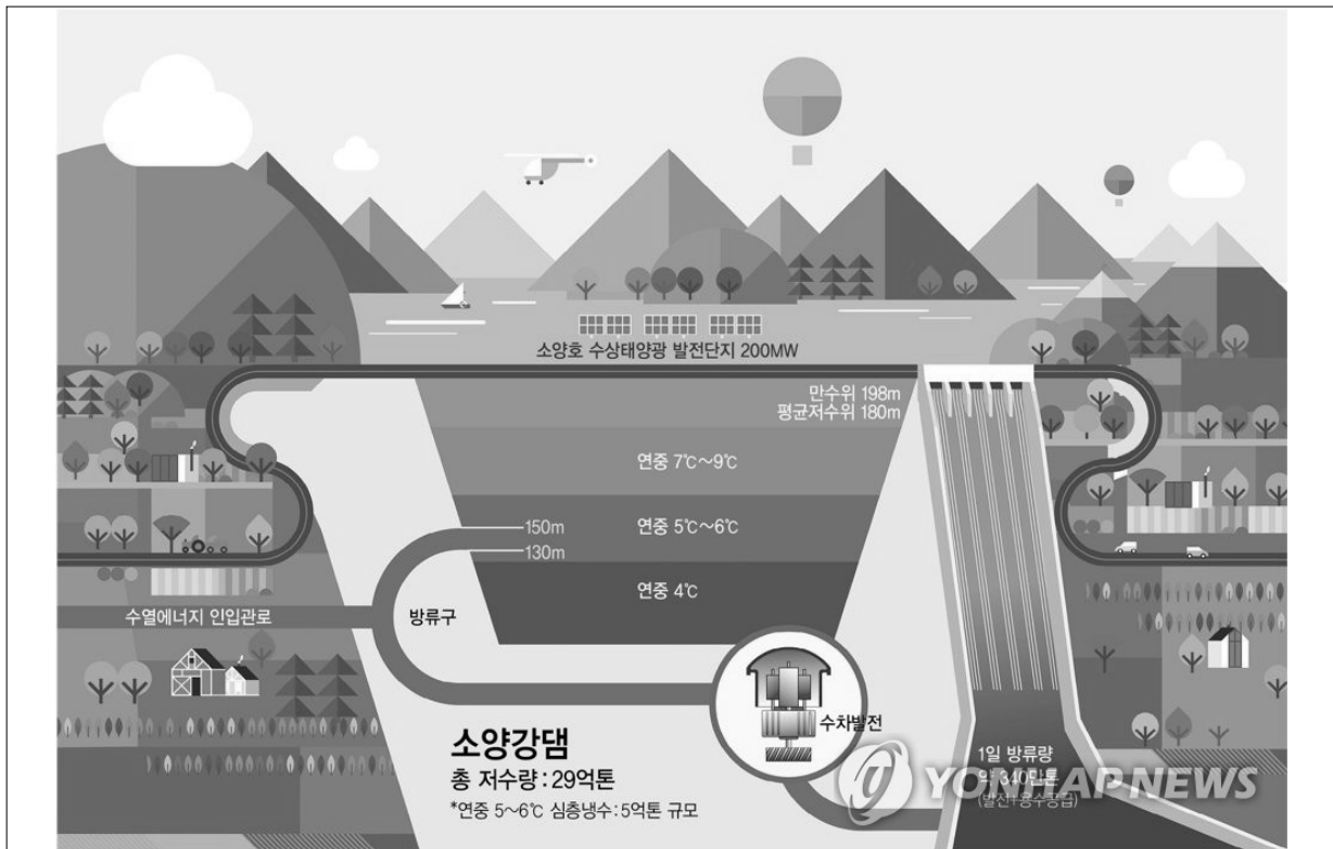
〈그림 III-31〉 소양강댐 수열 에너지 발생 개념도
