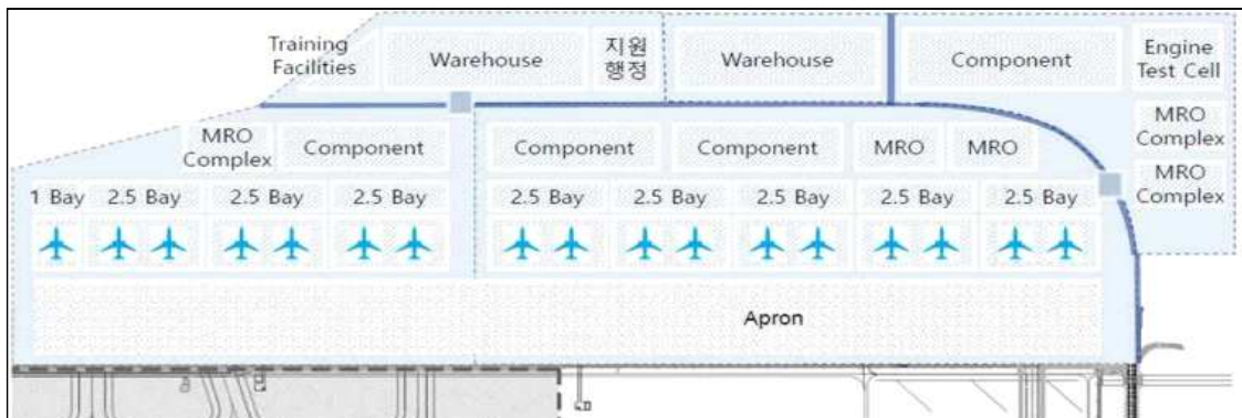
<그림 2-32> 인천국제공항 MRO 클러스터 조성 Site Plan
