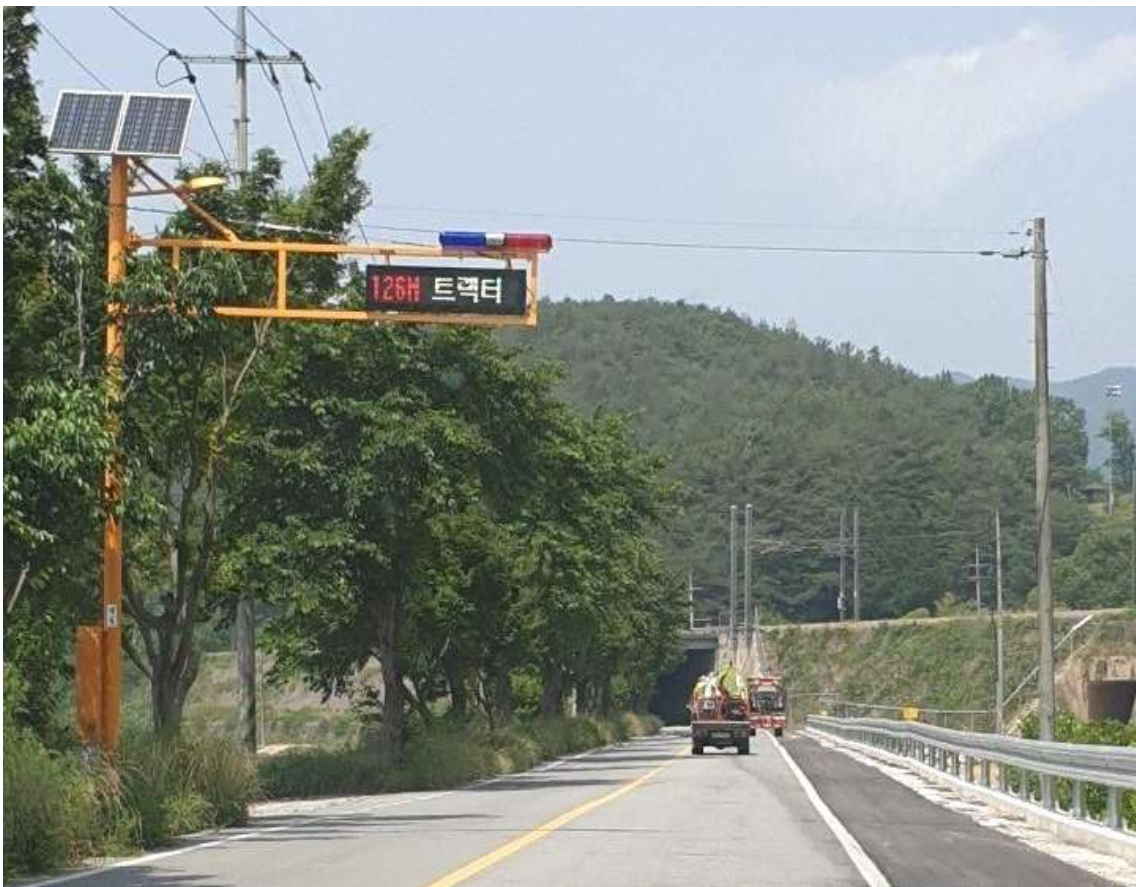
<붙임 3> 농기계 교통안전 알람 시스템 주행 테스트(농촌진흥청 제공)
