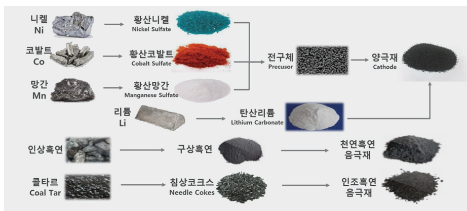
<그림7.1.1>전기차용 배터리 양극/음극재 가치사슬
