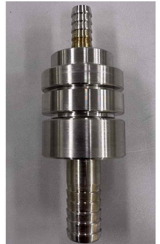
미세플라스틱 시료 채취 장치(자체 제작)
