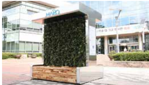
▲ 레이저 센서로 주변 공기 질을 확인하여 전방 0.5~1M의 공기를 정화할 수 있는 공기 정화 벤치 설치
