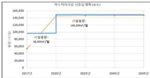
그림 7-69. 송도공공하수처리시설 시설용량 증가 예시 그림 7-70. 송도 공공하수처리시설 배치계획 예시
