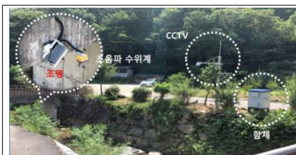
그림 7-125. 자동유량계측기술 설치 사례
