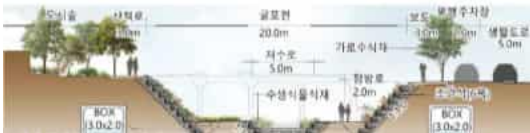
[그림 II - 18] 굴포천 생태하천복원 사업 구간 표준단면
