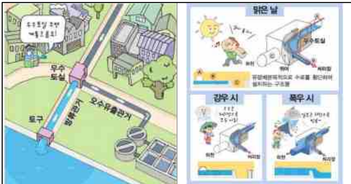
[그림 3.3-1] 합류식 토구(우수토실) 모식도(자료:하수도정보시스템)
