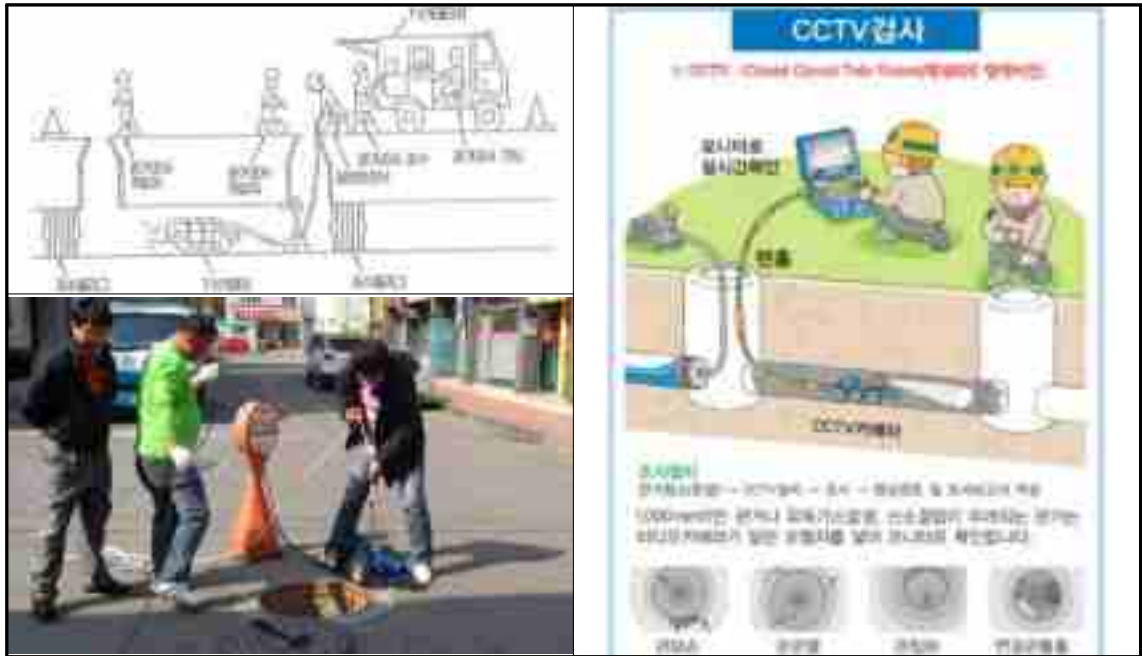
[그림 3.3-22] 관거누수 및 오염 확인을 위한 CCTV검사(출처:한국환경공단, 투데이광주)
