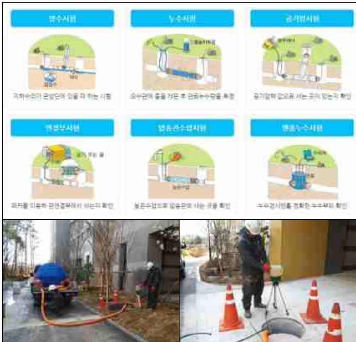
[그림 3.3-23] 관거누수 및 오점 확인을 위한 수밀검사(출처:한국환경공단, 수도써앤지)
