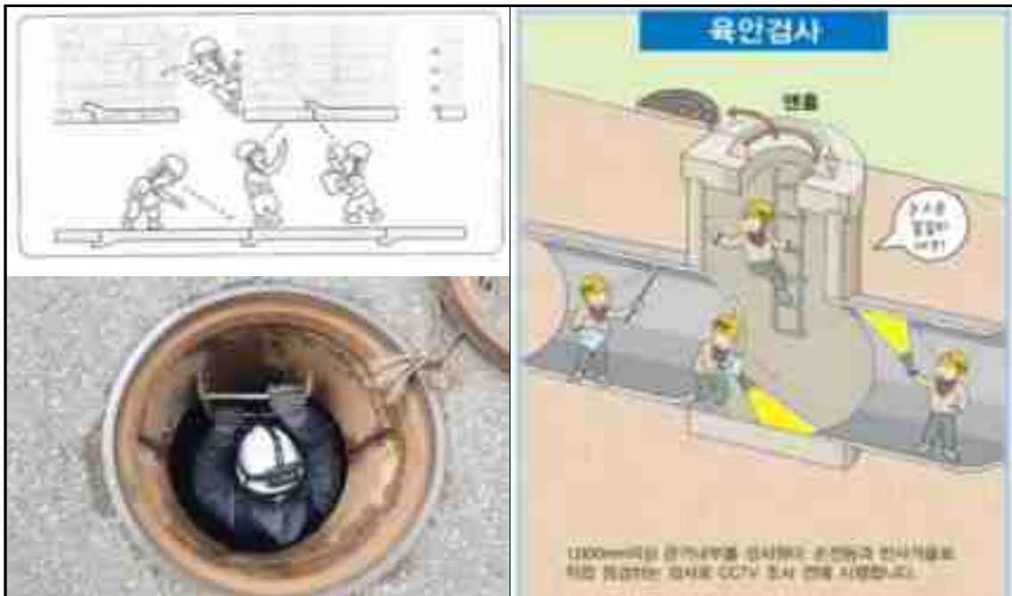
[그림 3.3-21] 관거누수 및 오점 확인을 위한 육안검사(출처:한국환경공단,(주)싱크워터)
