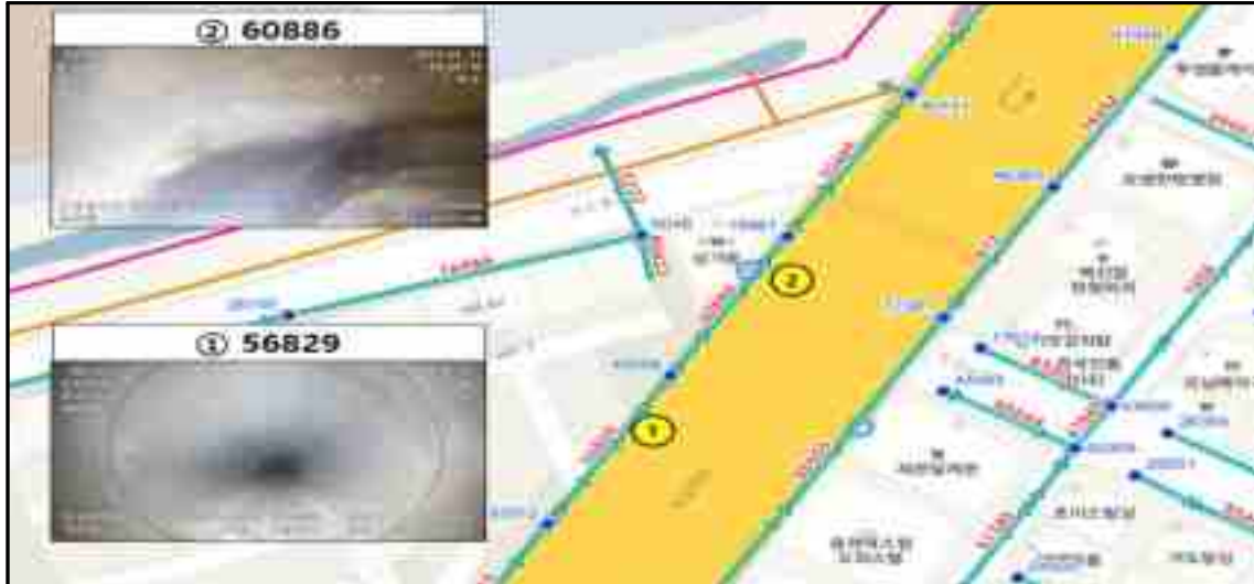
[그림 3.3-4] 용현수로 CCTV조사 결과
