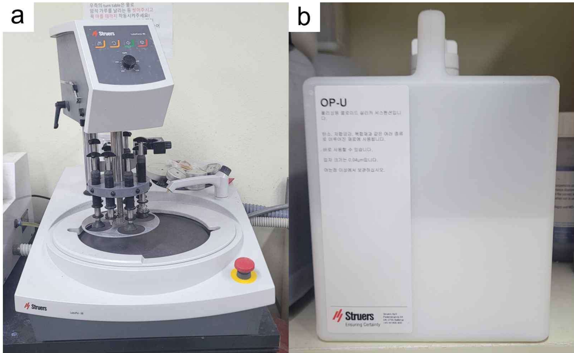
그림 1 (a) 미구조 분석을 위한 고품질 표면을 얻기 위해 시료 준비 과정에 사용된 연마기. (b) EBSD 데이터의 품질 향상을 위해 최종 연마 단계에서 사용된 SYTON(콜로이드 실리카) 용액.
