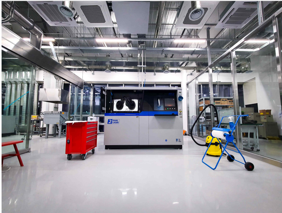
▲ 인천산학융합원 항공산업장비센터 적층제조 Lab. 내부 전경 * 사진 속 장비는 이번 공정개발에 활용된 GE 사의 M2 장비이다
