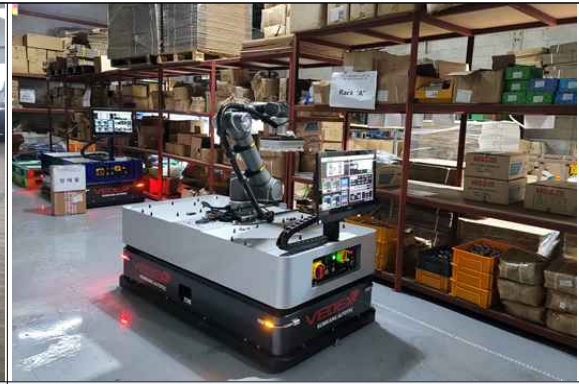
로봇암(Robot arm) 적용 무인이송로봇
