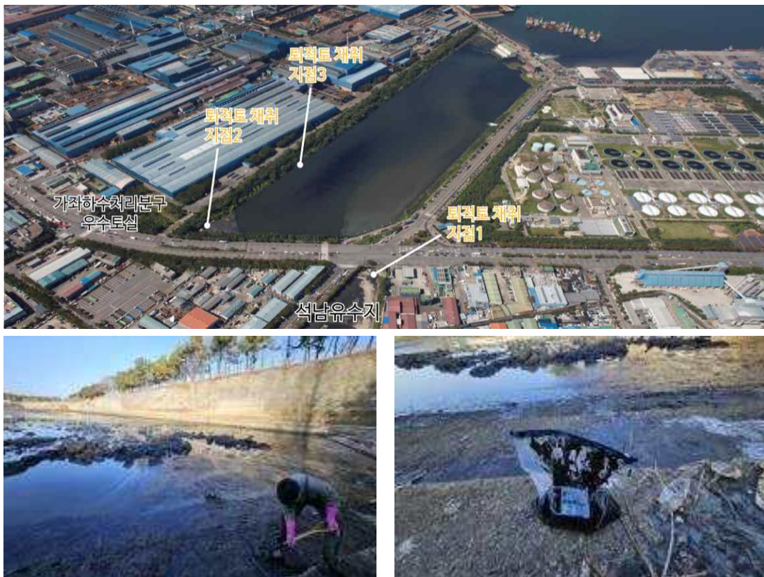
가좌하수처리분구 우수토실 퇴적토 채취
