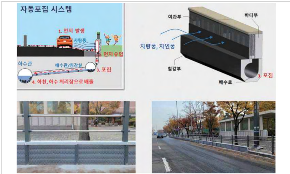
[그림 5-22] 도로 날림먼지 포집시스템
