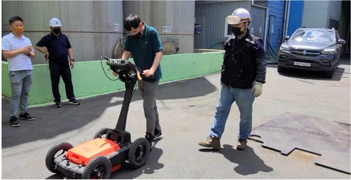
폐수배출사업장에서 GPR(지표투과레이더) 장비를 이용하여 지하 매설관로를 탐사하고 있다.
