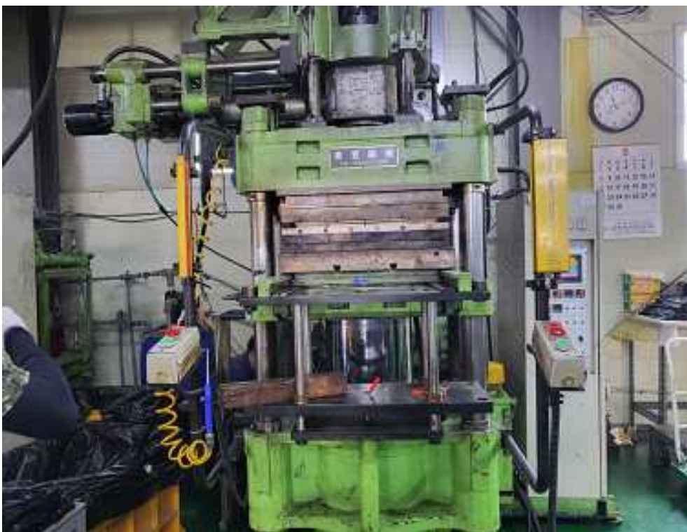
고무제품을 생산하는데 사용하는 가황시설 설치 사진
