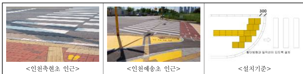
[그림 5-15] 점자블록 설치 오류
