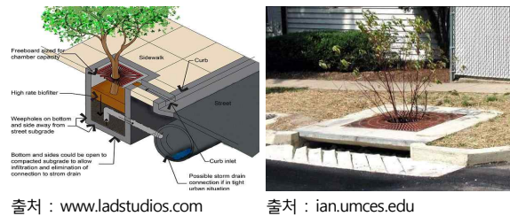
<그림 3> 가로수 저류박스 모식도(좌)와 적용사례(우)
