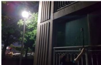
그림 5.11 평행한 상태의 공간조명 조도 측정의 예
