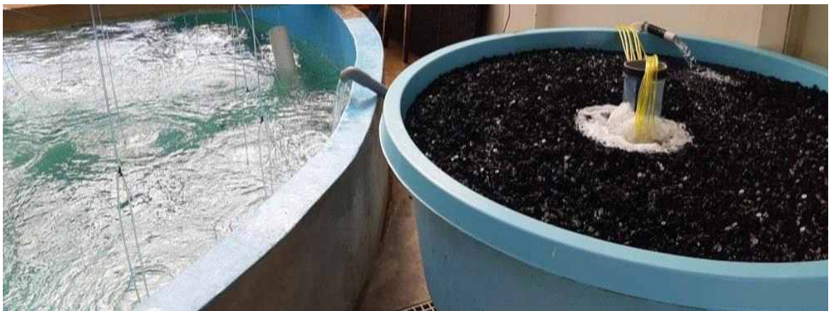
그림 1. 실험수조 모식도 및 유동상여과재 여과조(생물학적여과조)
