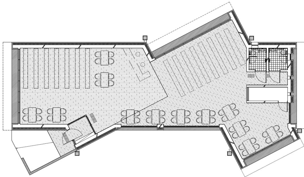
약 65평 남짓되는 작은 건축물이어서 기둥이 없는 건축물을 만들다보니 벽체만으로 하중을 견뎌야하므로 두께 30CM의 두터운 콘크리트 용벽이 만들어졌으며 가장 길이가 긴 용벽 쪽에 만들어진 창은 자연스럽게 깊이감이 생겼고 구조적으로 안정적인 평면을 만들어야 하는 동시에 주변 공원 전망을 극대화하기 위한 커튼월 창을 많이 만들어야하는 두가지 숙제를 풀어야만 했다.
