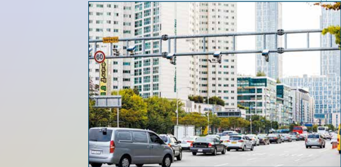
차량번호 인식 시스템. 송도를 출입하는 모든 차량의 번호가 인식되어 사건·사고 발생시 차량의 경로추적이 가능하다.
